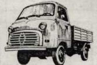
un camión ligero para 800 kgs. de carga, que anda a 100 kms. por hora y tiene 47 cv. de potencia.
