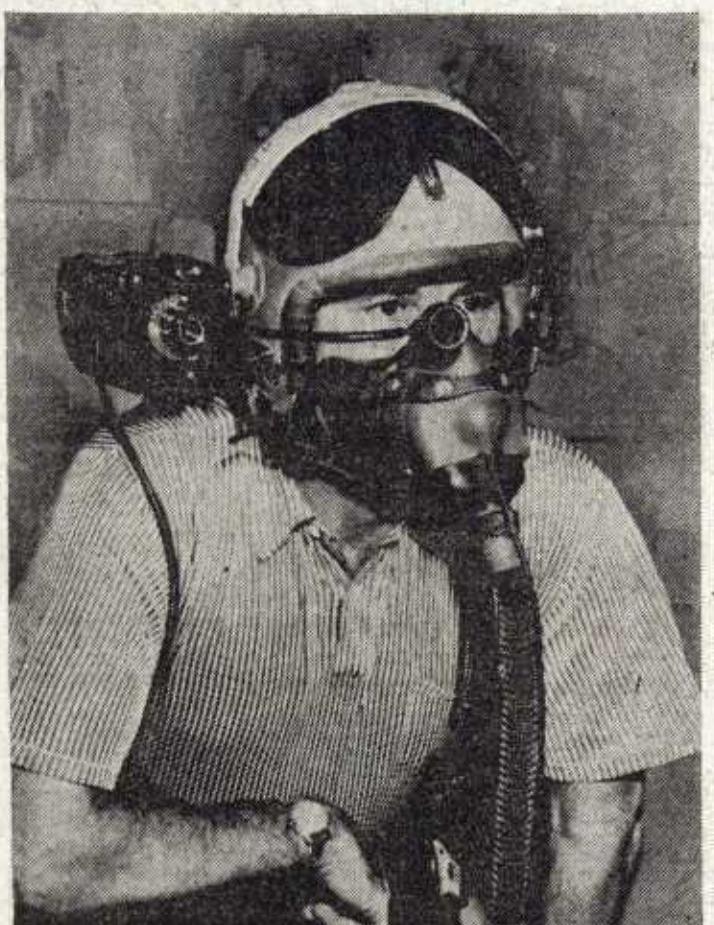
A veces el piloto tiene que hacer algo más que llevar los mandos de su avión. Este, por ejemplo, dispone de un casco de vuelo al que va unida una cámara fotográfica modificada. La cámara fue fabricada para ser utilizada por los pilotos de caza de reactores supersónicos mientras vuelan a grandes velocidades.
